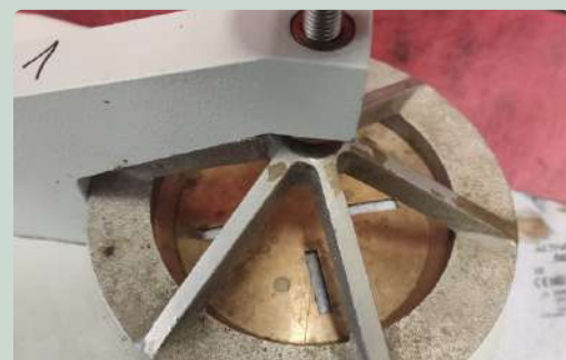
Fig. 3 Watertightness test - UNI EN 1928
